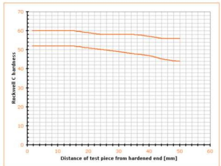
Ilustración 1.1 - Diagrama de templabilidad aplicable para un AISI 4340
